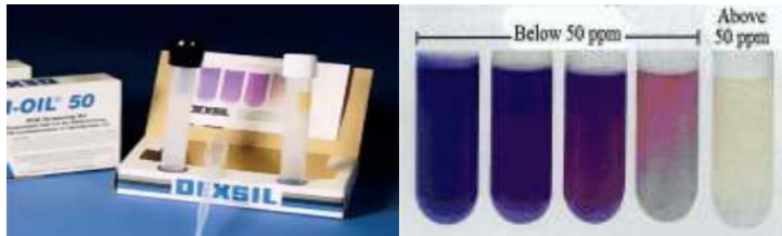
SLIKA 1 - Kolorimetrijska metoda za određivanje sadržaja PCB test kitovima
