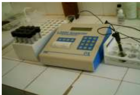
SLIKA 2 - Elektrohemijska metoda za određivanje sadržaja PCB jon-specifičnom elektrodom
